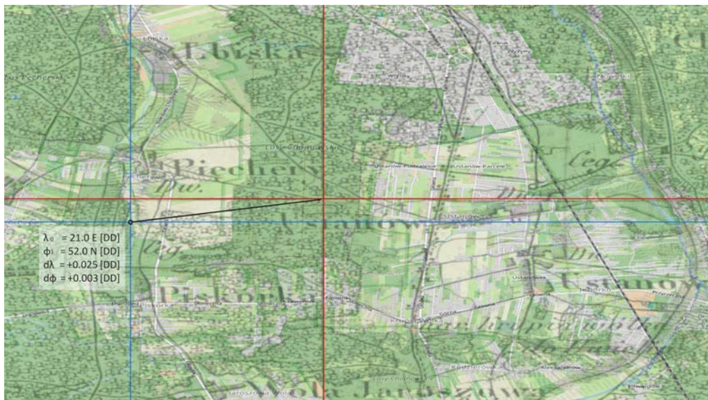
Ryc 6. Lokalizacja punktu początkowego układu współrzędnych, tj. przecięcia Południka Warszawskiego i równoleżnika 52 N. Na arkuszu TKKP Kol. IV, Sek. IV współrzędne TKKP – linia czerwona, współrzędne WGS 84 – linia niebieska. Wektor przesunięcia siatki 10-minutowej z punktu 21 E, 52 N do punktu początkowego TKKP wyniósł d\lambda = +0,025 DD oraz d\phi = +0,003 DD; podkład OSM
