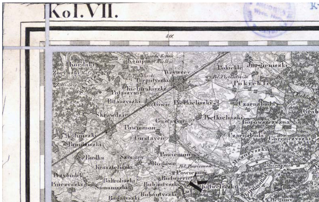
Ryc. 3. Fragment arkusza Kol. VII. Sek. II. ze zbiorów Biblioteki Uniwersyteckiej im. Jerzego Giedroycia w Białymstoku. Warto zwrócić uwagę na nieprawidłowo odciętą ramkę mapy, w wyniku czego następuje utrata do ok. 0,5 mm treści (ok. 63 m w terenie). Wielkość oryginalna
