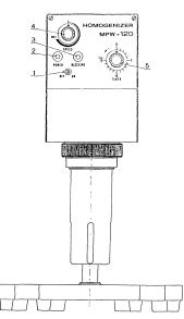
Fig. 8. Head of homogenizer:
