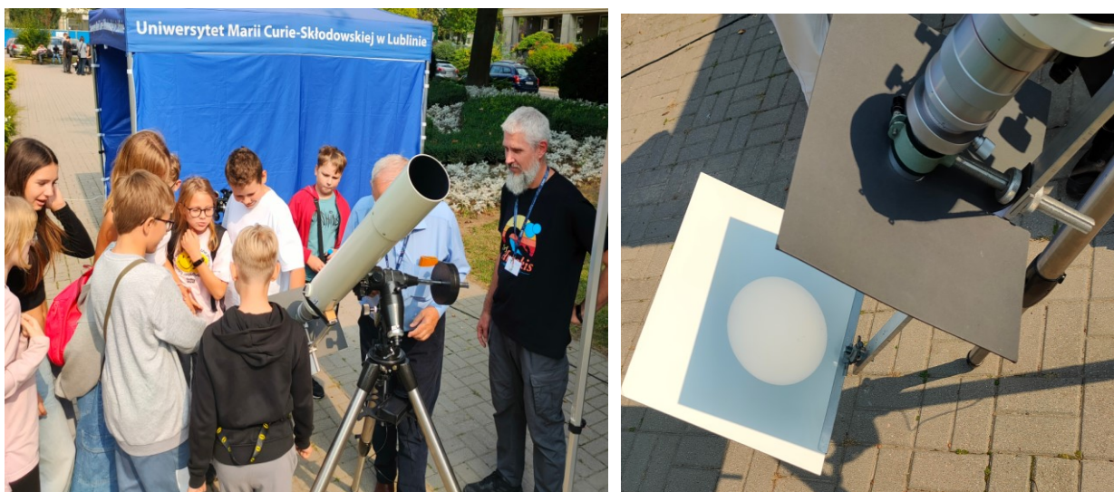
Fot. 4. Refraktor Zeissa o średnicy 100 mm i ogniskowej 1000 mm na montażu paralaktycznym CG5 wykorzystany na pokazach do projekcji okularowej powierzchni Słońca rzutowanej na biały ekran. (fot. T.Kwapiński)
