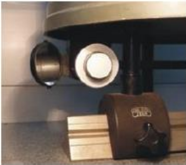
Rys. 2 Śruba mikrometryczna monochromatora do regulacji położenia pryzmatu względem padającej wiązki światła.
