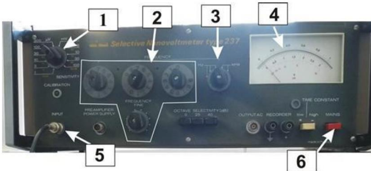
Rys. 8 Nanowoltomierz selektywny typ 237 1 – pokrętło zmiany zakresu napięcia 2 – pokręta dostrajania częstotliwości odbioru sygnału 3 – pokrętło zmiany zakresu częstotliwości (Hz, kHz) 4 – wyświetlacz mierzonego napięcia 5 – gniazdo wejściowe sygnału 6 – włącznik/wyłącznik sieciowy nanowoltomierza
