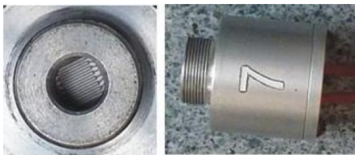
Rys. 10 Fotoelement nr. 7: fotorezystor typ RPP131, lewy panel – widok z góry, prawy panel – widok z boku: widoczne są kable zasilające fotoelement oraz gwint do przymocowania fotoelementu do szczeliny wyjściowej monochromatora.
