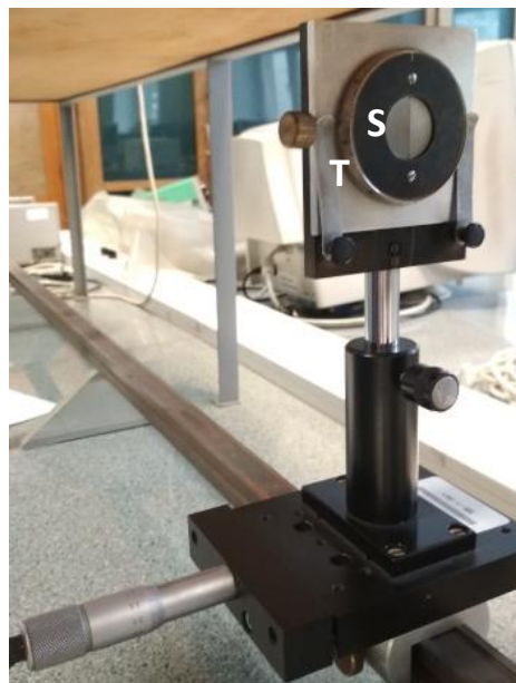
Rys 6. Pojedyncza szczelina (S) zamocowana na stoliku mikrometrycznym. Szerokość szczeliny regulowana jest metalowym pokrętkiem (T) ze skalą znajdującym się wokół szczeliny.
