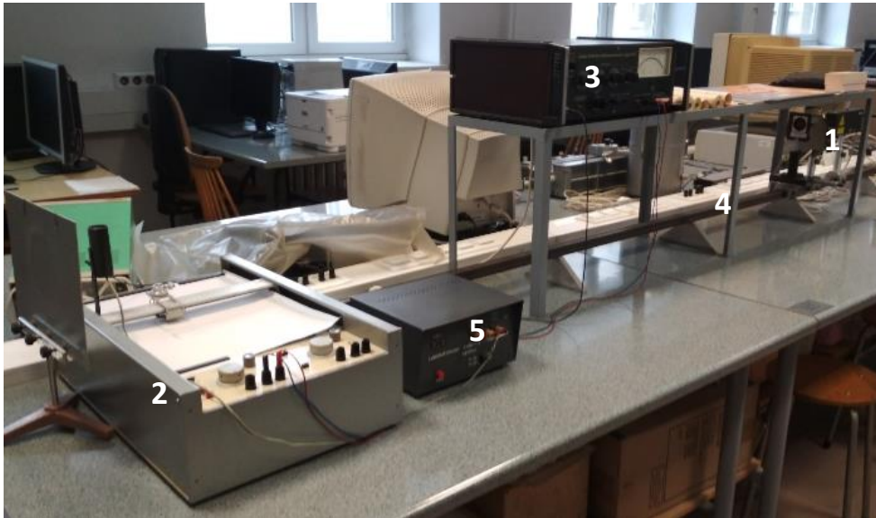
Rys. 1b Zdjęcie aparatury w eksperymencie Laser He-Ne: 1 – laser He-Ne, 2 – samopis, 3 – wzmacniacz selektywny, 4 – ława optyczna, 5 – zasilacz fotodiody krzemowej
