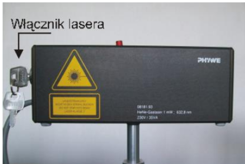
Rys. 2. Widok kompaktowego lasera He-Ne firmy PHYWE.
