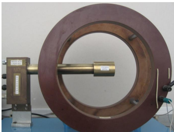
Rys.3. Autodyna i cewki Helmholtza wraz z próbką
