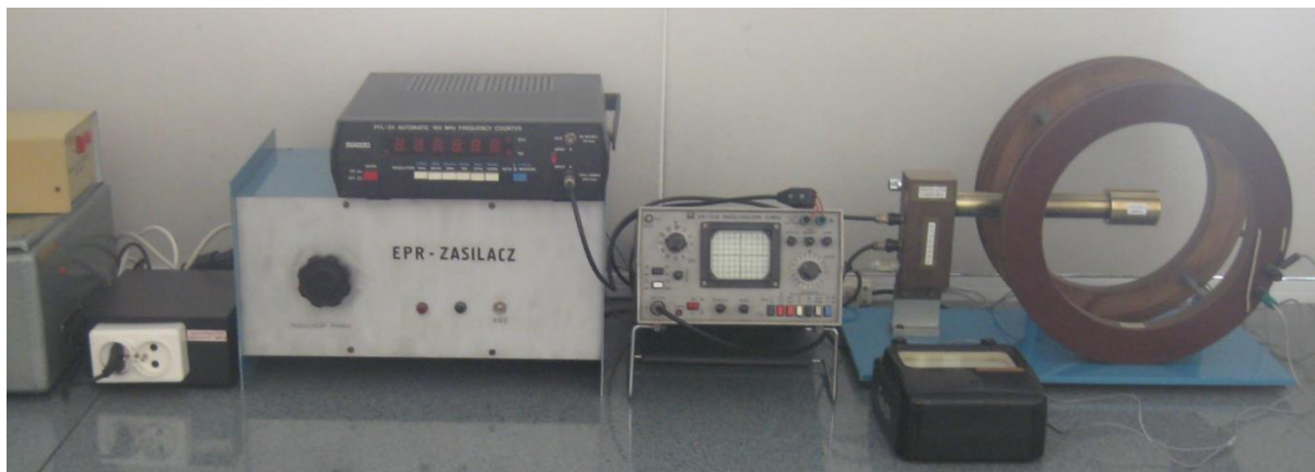
Rys.2. Wygląd zestawu pomiarowego do obserwacji zjawiska EPR
