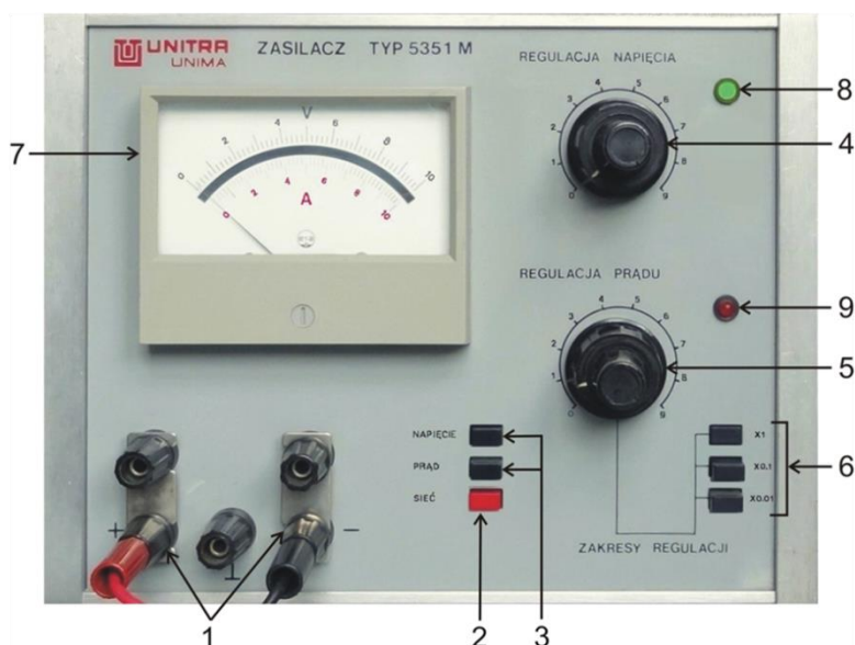
Rys. 13. Fotografia zasilacza stabilizowanego 5351 M. Oznaczenia: 1- gniazda wejściowe do oświetlacza, 2- włącznik sieciowy, 3- przełączniki napięcia i prądu, 4- pokrętko regulacji napięcia, 5- pokrętko regulacji prądu, 6- przyciski zakresów regulacji (mnożniki), 7- miernik napięcia i prądu, 8- dioda zielona, wskaźnik stabilizacji napięcia, 9- dioda czerwona, wskaźnik stabilizacji prądu.
