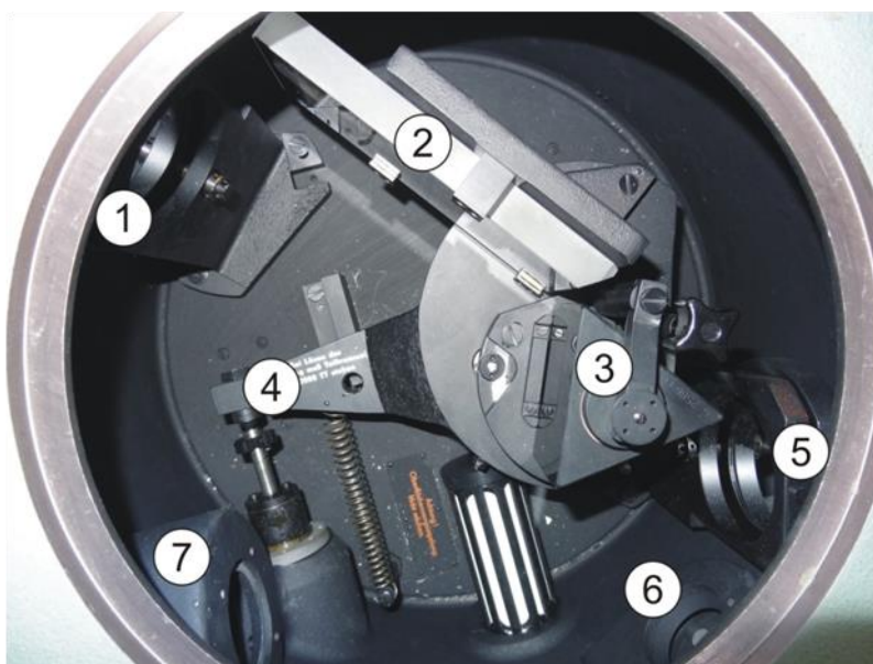
Rys. 5 Fotografia układu optycznego monochromatora SPM1 (po zdjęciu pokrywy). Na fotografii zaznaczono: 1- zwierciadło kolimacyjne, 2- zwierciadło płaskie, 3- pryzmat, 4- układ obrotu pryzmatu połączonego ze zwierciadłem płaskim, 5- zwierciadło wklęsłe, 6- szczelina wejściowa monochromatora, 7- szczelina wyjściowa monochromatora.
