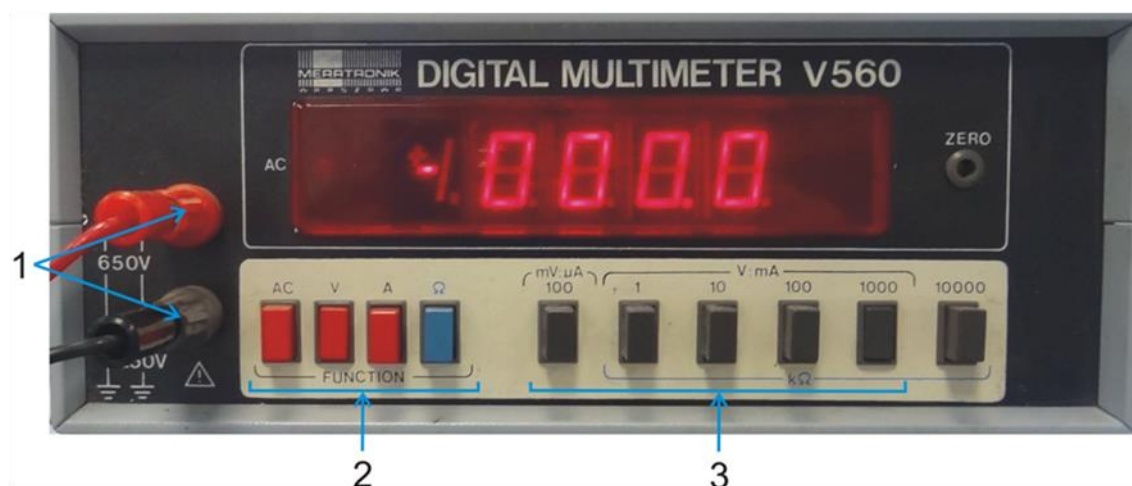
Rys. 11 Fotografia woltomierza cyfrowego V560 służącego do pomiaru napięć na detektorach: 1- gniazda wejściowe woltomierza, 2- przełączniki trybu pracy woltomierza, 3- przełączniki zakresów (czułości) woltomierza do pomiaru napięć i prądów.
