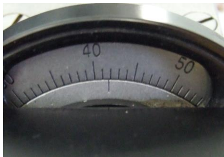
Rys. 2 Widok bębna z podziałką (element refraktometru) z którego odczytuje się liczbę z .
