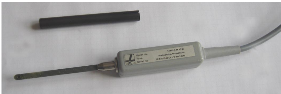
Rys. 7. Sonda hallowska do pomiaru indukcji magnetycznej z osłoną sondy (czarna rurka powyżej)
