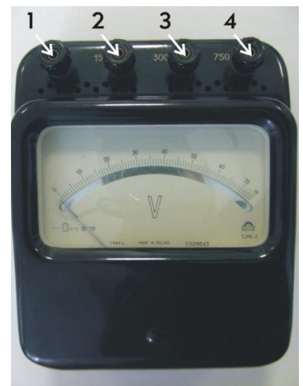
Rys. 8 Woltomierz magnetoelektryczny służący do pomiaru wartości napięcia na kondensatorze.
