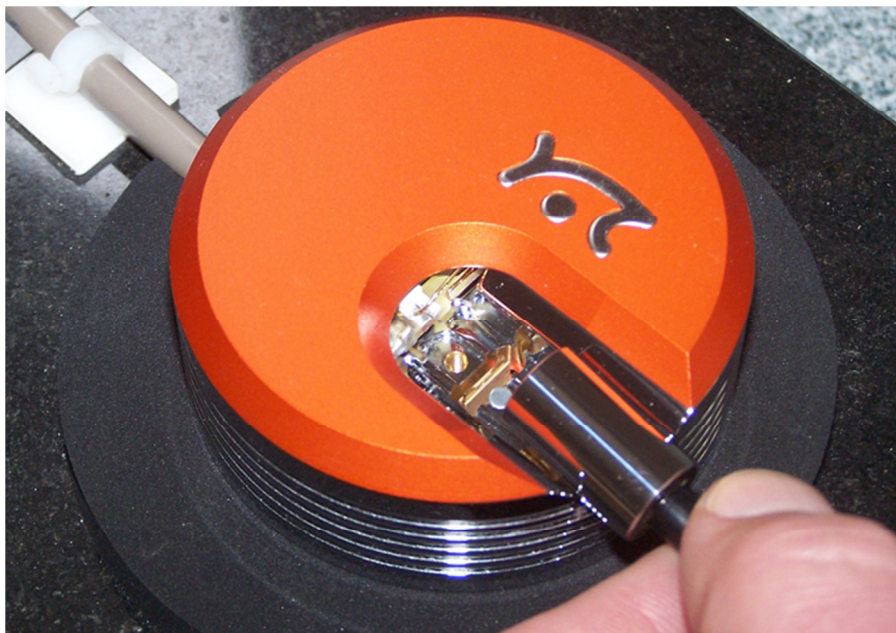
Rys. 14. Montowanie uchwyty z próbką w głowicy skanującej.
