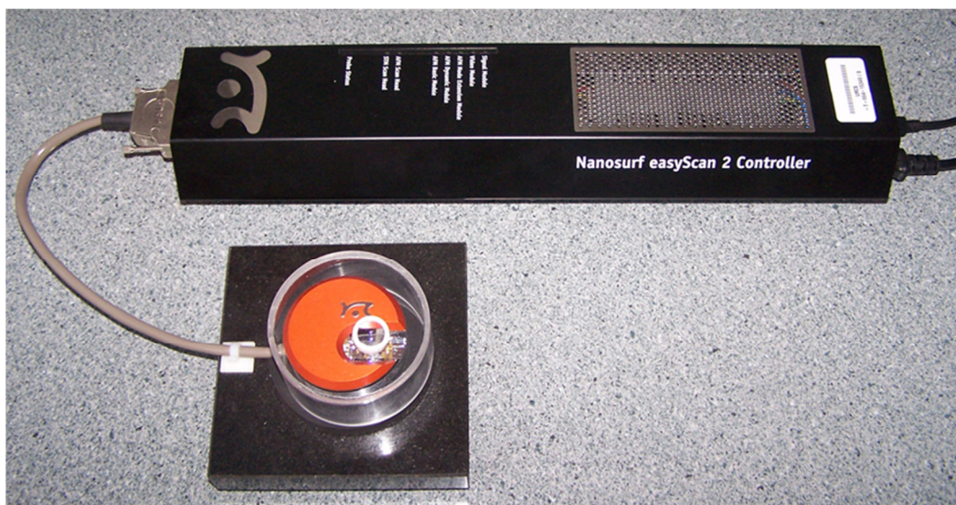
Rys. 6. Głowica i układ sterujący skaningowego mikroskopu tunelowego
