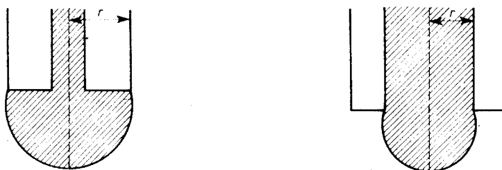
Rys. 4. Wypływ kropli dla cieczy zwilżającej powierzchnię stopki stalagmometru i cieczy nie zwilżającej.
