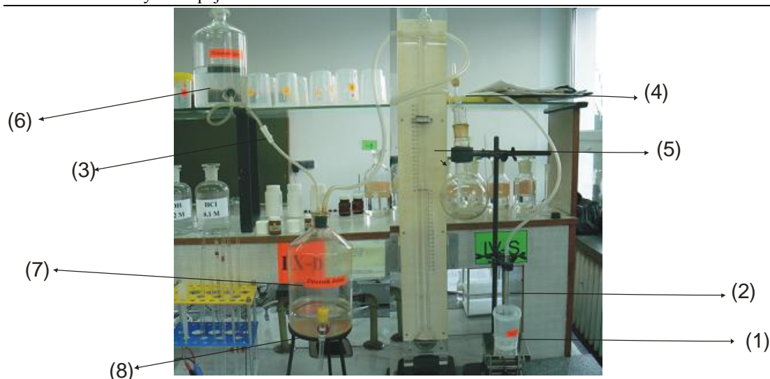
Rys. 2. Zestaw Rebintera do pomiaru napięcia powierzchniowego metodą maksymalnego ciśnienia baniek.
