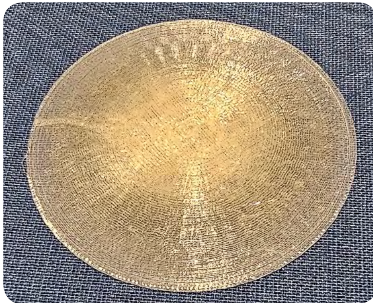
Fot. 1. Przykładowa soczewka wydrukowana technologią FDM
