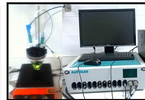
Potencjostat AUTOLAB 302N (Eco Chemie, Holandia) oraz standardowy układ trójelektrodowy stosowane do pomiarów metodą CV
