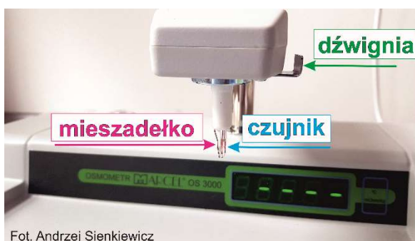
Rys. 9. Budowa głowicy pomiarowej osmometru Marcel OS 3000.
