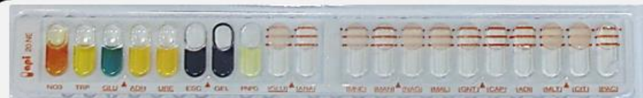
Test biochemiczny API do określenia zdolności mikroorganizmów do asymilacji, fermentacji lub degradacji określonych związków chemicznych
