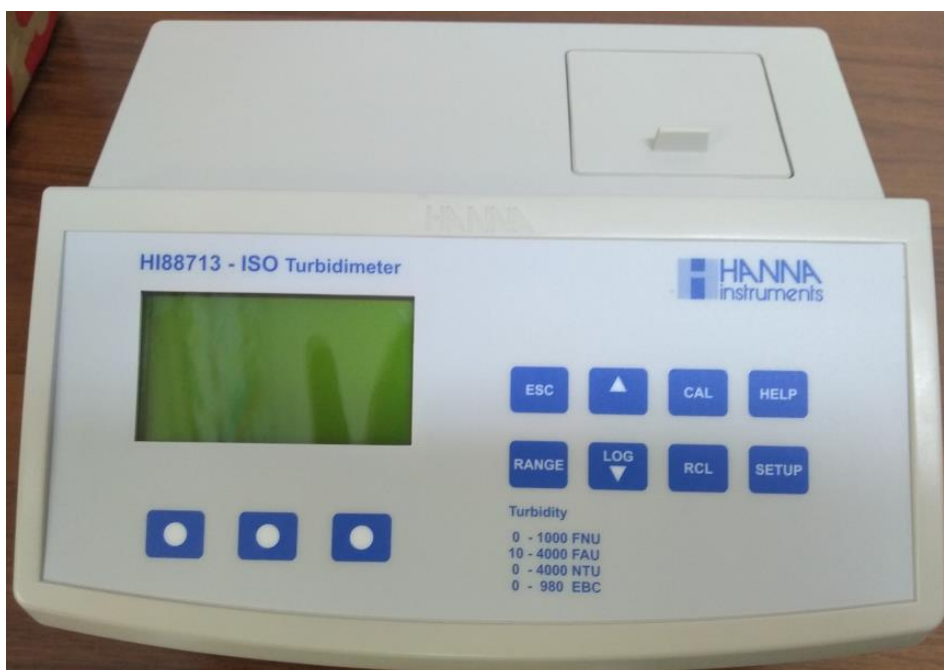
Rys. 4. Mętnościomierz HI88713, HANNA Instruments.
