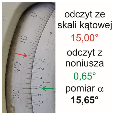
Rys. 4. Sposób odczytu kąta skręcenia płaszczyzny polaryzacji światła na lewej skali polarymetru po ustawieniu jednorodnego zaciemnienia pola w okularze polarymetru (rys. 3c). Zero noniusza znajduje się pomiędzy 15° a 16° znacznika skali kątowej, stąd odczyt 15,00°. Patrząc od 0 do 10 na skali noniusza, podziałka odpowiadająca wartości 6,5 tworzy ciągłą linię ze znacznikiem skali kątowej, stąd odczyt części ułamkowych kąta \alpha równy 0,65°.
