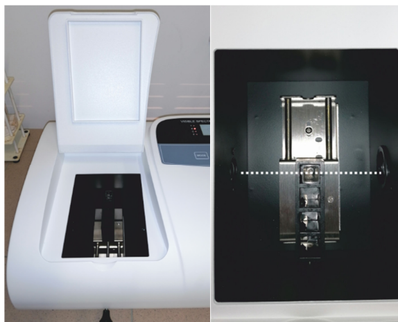
Rys. 7. Cella pomiarowa i jej wnętrze z zaznaczoną drogą optyczną wiązki światła (biała przerywana linia).
