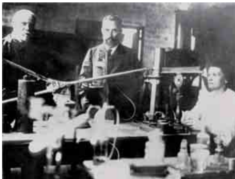
Maria Curie przy pomiarach radioaktywności z wykorzystaniem elektrometru piezoelektrycznego, obok Piotr Curie i chemik Gustave Bémont
