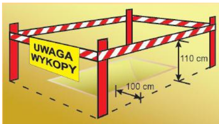
Przykład zabezpieczenia wykopu.
