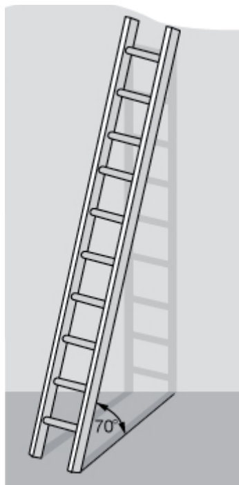
Właściwy kąt ustawienia drabiny.
