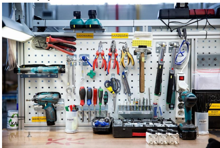
Tablica cieni, czyli prosty sposób na uporządkowanie stanowiska pracy.
