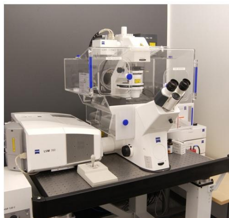
Rys. 10 Zdjęcie mikroskopu konfokalnego LSM 780 Zeiss
