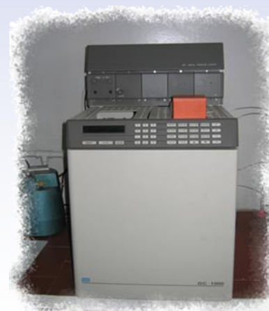
DANI GC 1000 z detektorem FID i TCD
