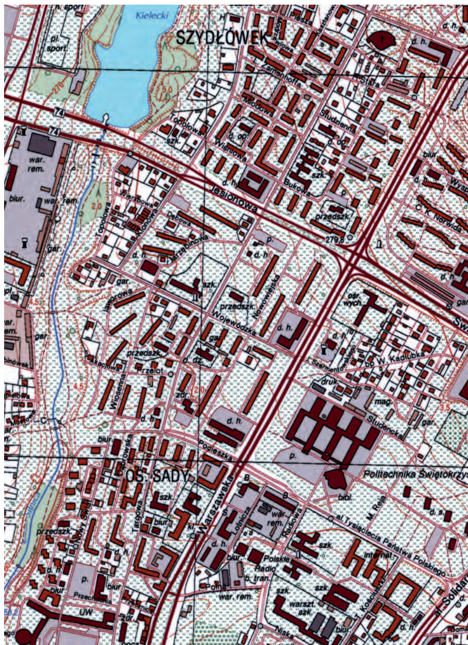
Ryc. 13. Brak nazwy dodatkowej „OS. SADY” na mapie topograficznej 1:10 000 w układzie PL-1992 w standardzie TBD. Przesunięto nazwę „SZYDŁÓWEK”, gdyż zbyt ciemne budynki zabudowy luźnej wielorodzinnej znacznie obniżyłyby jej czytelność
