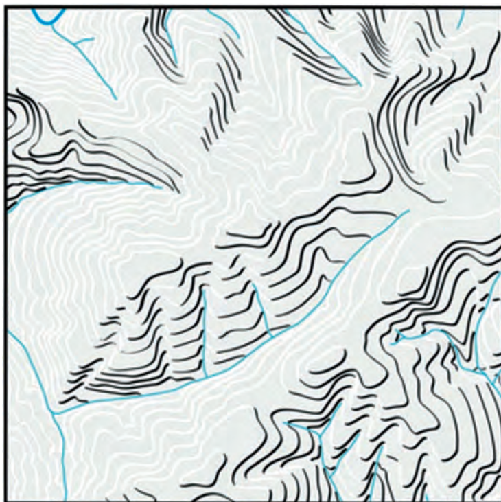
Ryc. 17. Poziomice iluminowane. Źródło: https://www.behance.net/gallery/19561371/Rzezba-terenu
