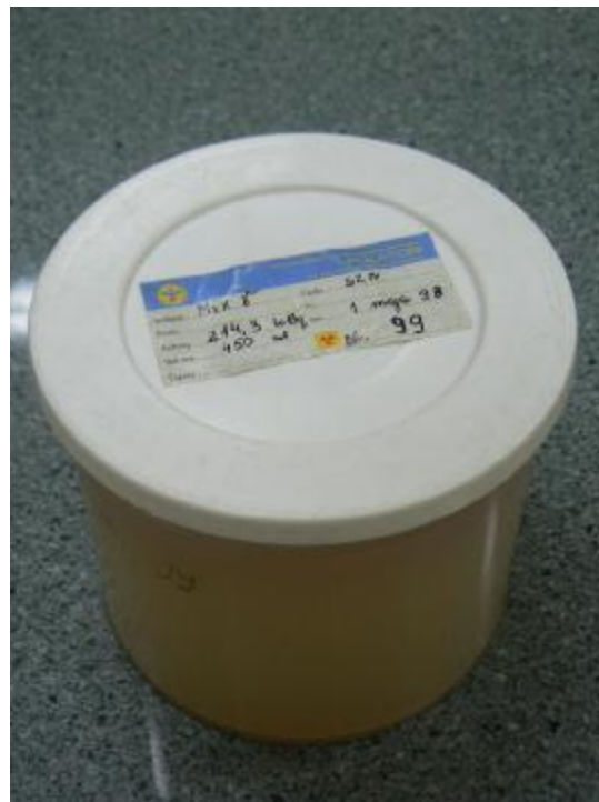
Fot. 2. Naczynie Marinelli zawierające źródło wzorcowe do kalibracji.
