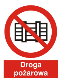
Rys. 24. Oznakowanie drogi pożarowej.
