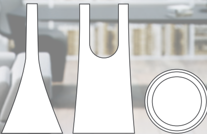
dekoracyjna zwieszana oprawa na źródła światła LED moc 45W | strumień oprawy 3050lm | CRI/Ra 80
