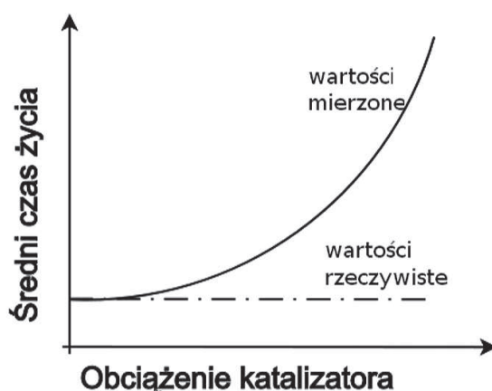
Rys. 9. Metoda korekcji wartości średniego czasu życia półproduktów o wielkość readsorpcji produktów na powierzchni ziaren katalizatora [4].
