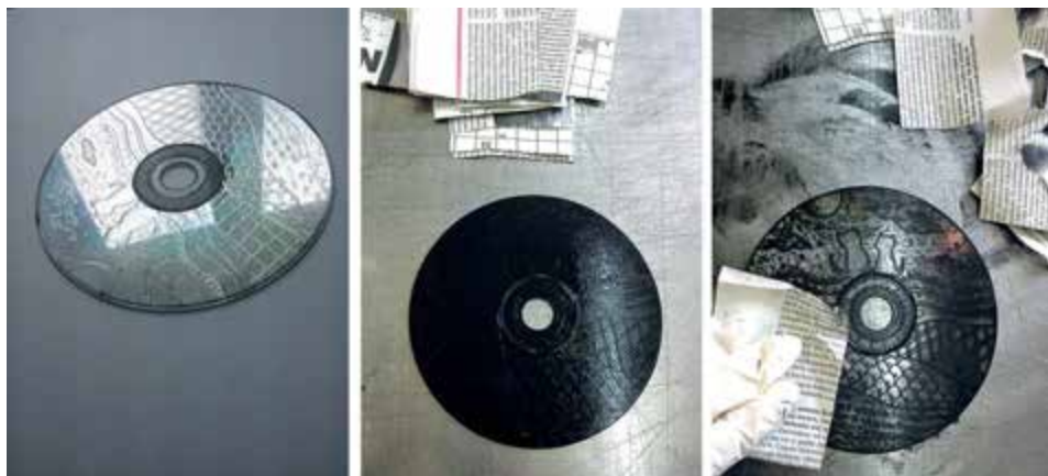
Ryc. 15. Matryca suchorytnicza wykonana na płycie CD; matryca z wtartą farbą oraz matryca w trakcie wycierania powierzchni z farby
