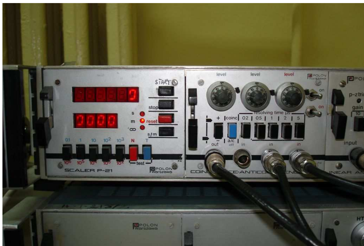
Fot. 2. Przelicznik i Wzmacniacz liniowy WL - 21
