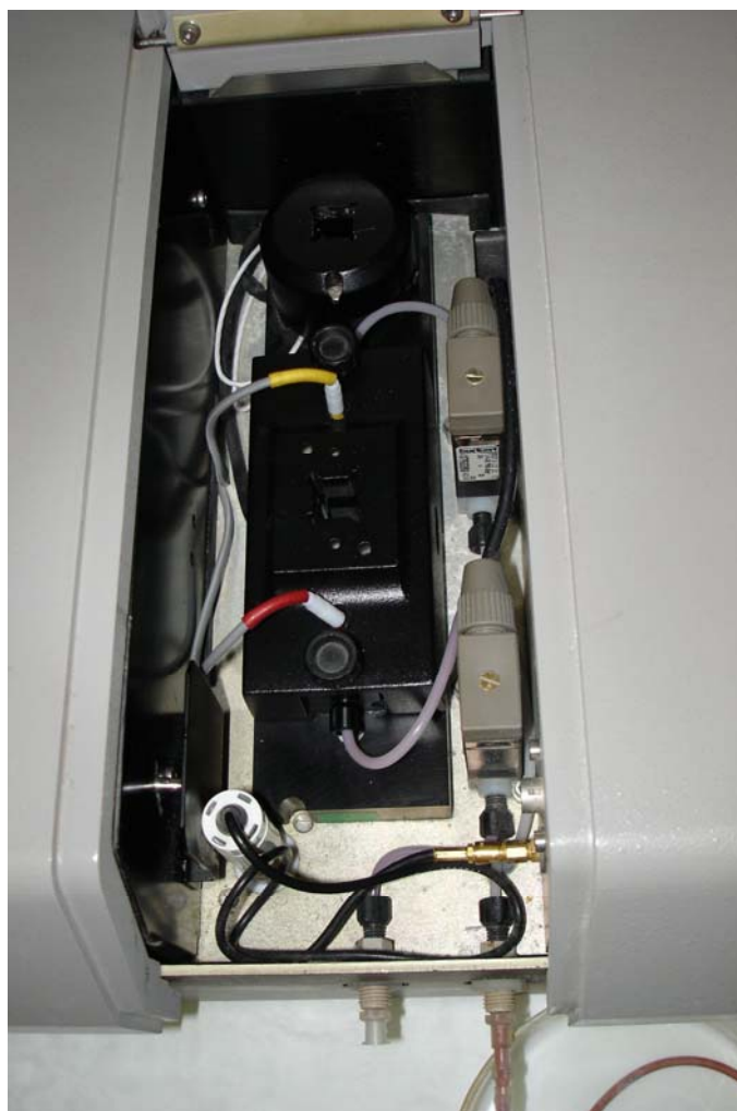
Rysunek 2. Cella pomiarowa zetametru Zetasizer 3000.
