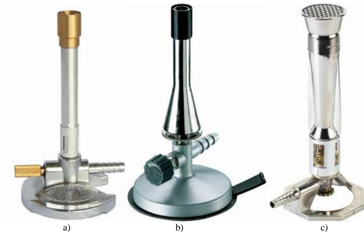
Rys. 5. Palniki gazowe: a) Bunsena, b) Teclu, c) Meckera.
