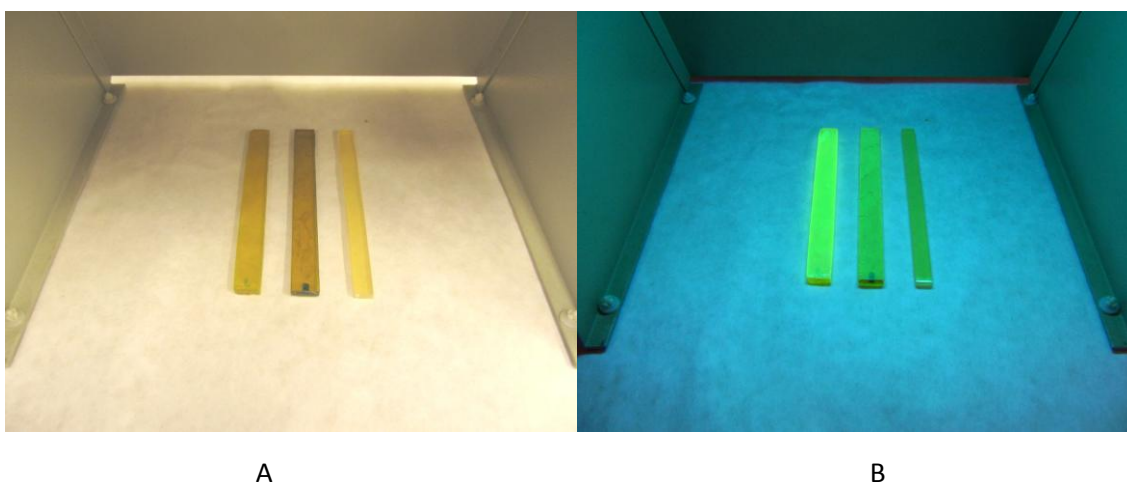
Rys. 18 Zdjęcie kopolimerów poddanych promieniowaniu UV (B) lub brak naświetlania (A)
