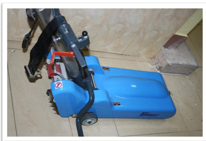
Schodółaz pomagający pokonać trzy stopnie w holu głównym.
